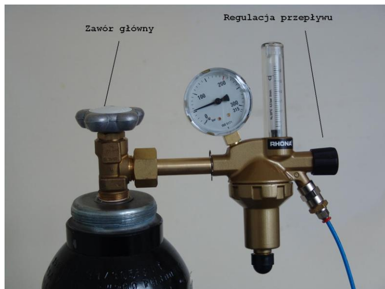
Rys. 6b. Otwarcie zaworu głównego i ustawianie przepływu
