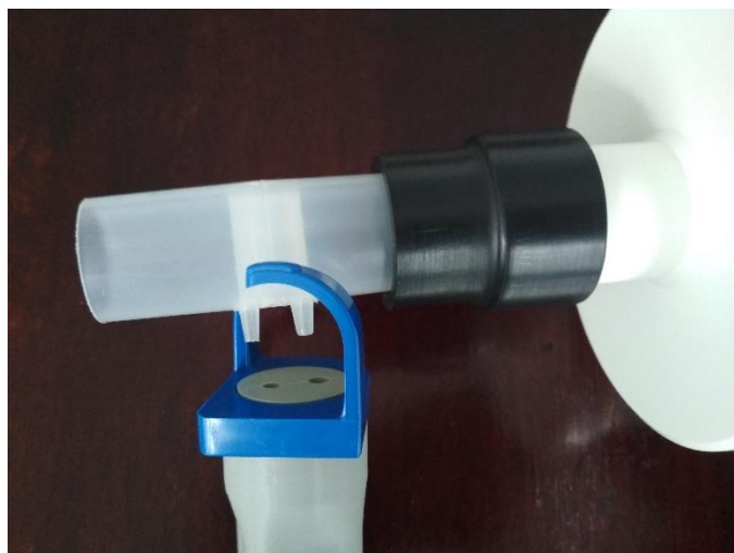
Rys. 5a: Podłączanie głowicy do przewodu powietrznego
