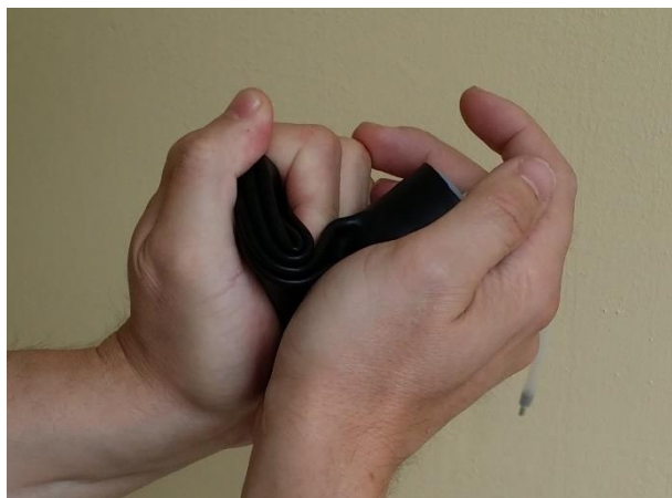
Rys. 6a. Wyciskanie resztek powietrza z worka kalibracyjnego
