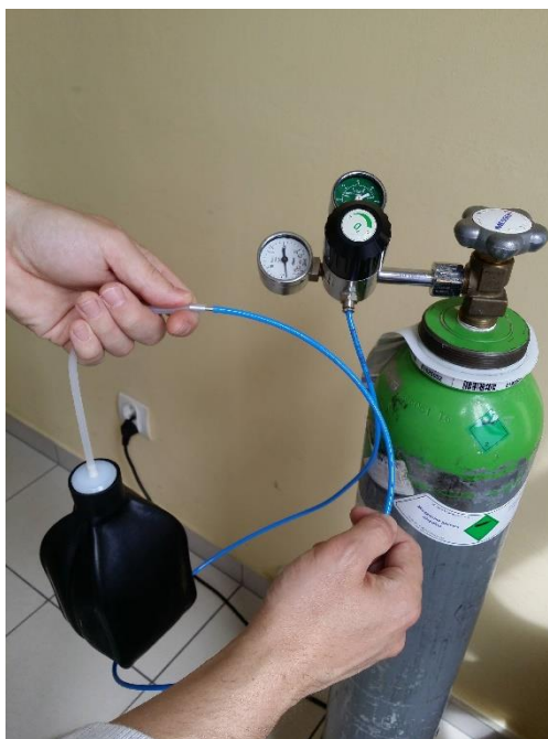
Rys. 6b. Pobieranie gazu z butli
