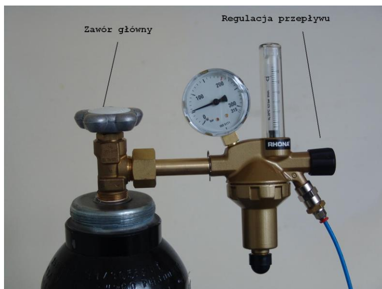
Rys. 6b. Otwarcie zaworu głównego i ustawianie przepływu
