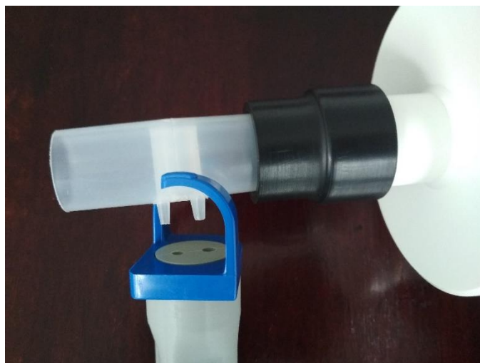
Rys. 5a: Podłączenie głowicy do przewodu powietrznego
