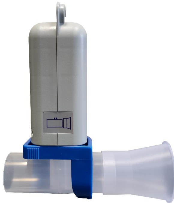
Rys 17 Prawidłowo podłączony układ pomiarowy z głowicą i ustnikiem
