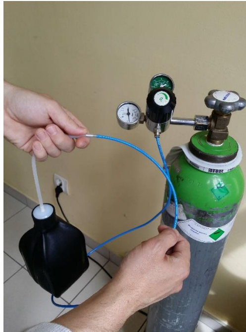
Rys. 6b. Pobieranie gazu z butli
